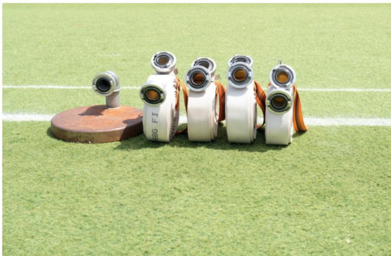
Abb. 12: Aufstellung der vier C-Druckschläuche
