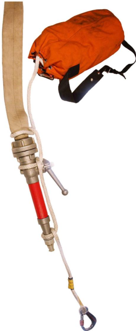
Abb. 51: Kreuzklank und halber Schlag am Strahlrohr (ÖBFV)
