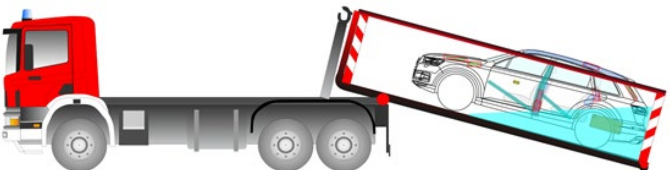
Abbildung 12: Schrägstellung der AB Mulde um ein einlaufen des Wassers in die HW-Batterie zu ermöglichen
