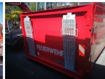
Rückwand, Schwenktür rechts öffnend, inkl. Auffahrschienen
