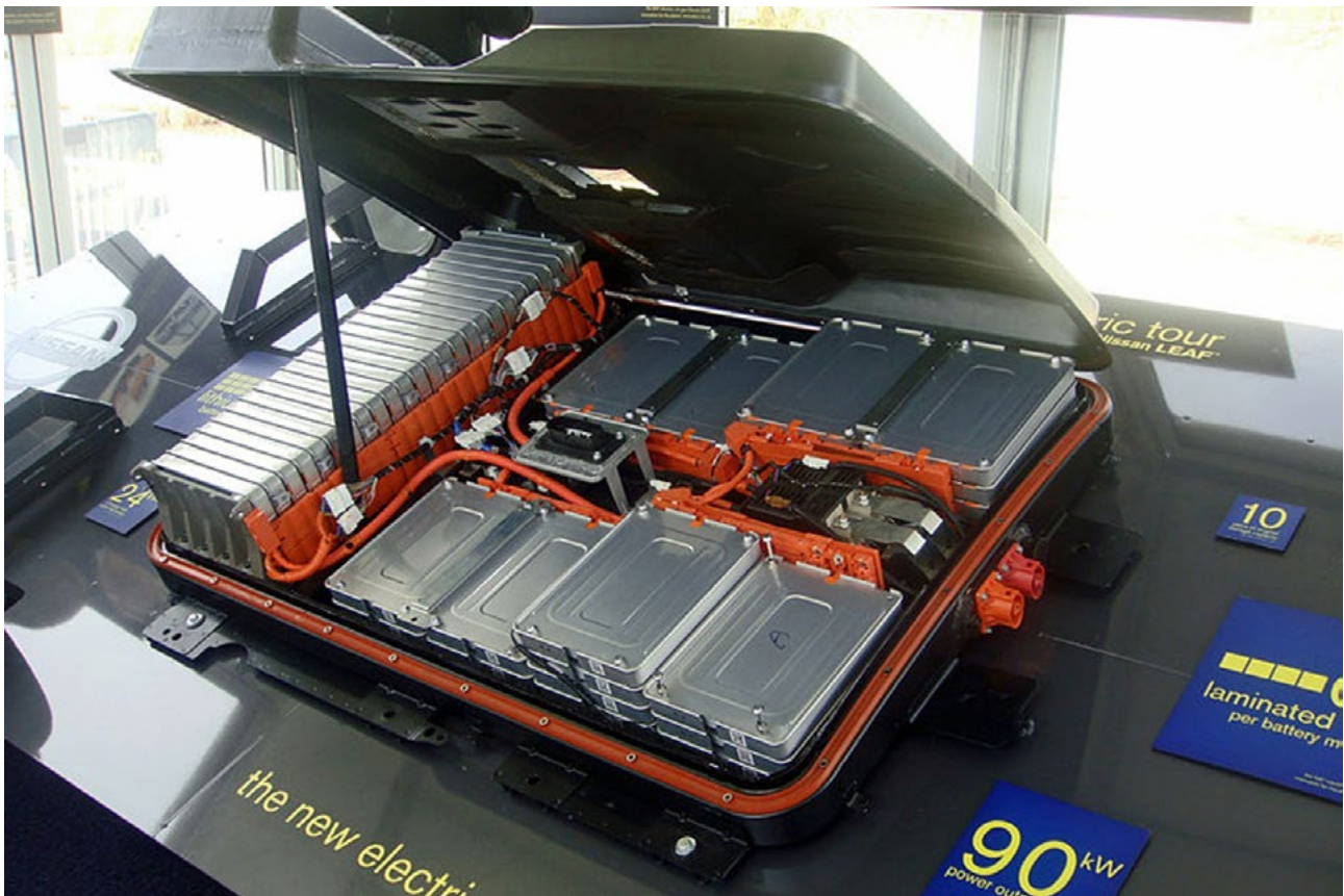
Abbildung 3: HV-Batterie-Pack Nissan Leaf
