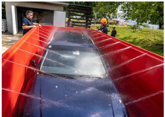
Abbildung 10: Sprinklung eines PKW's in der AB Mulde
