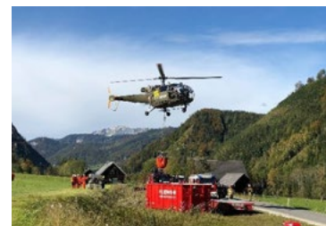
Befüllen mittels Löschbehälter und Hubschrauber
