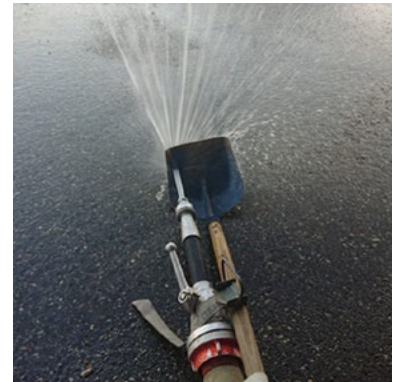
Abbildung 5: Strahlrohr mit Fassschaufel als Prallblech
