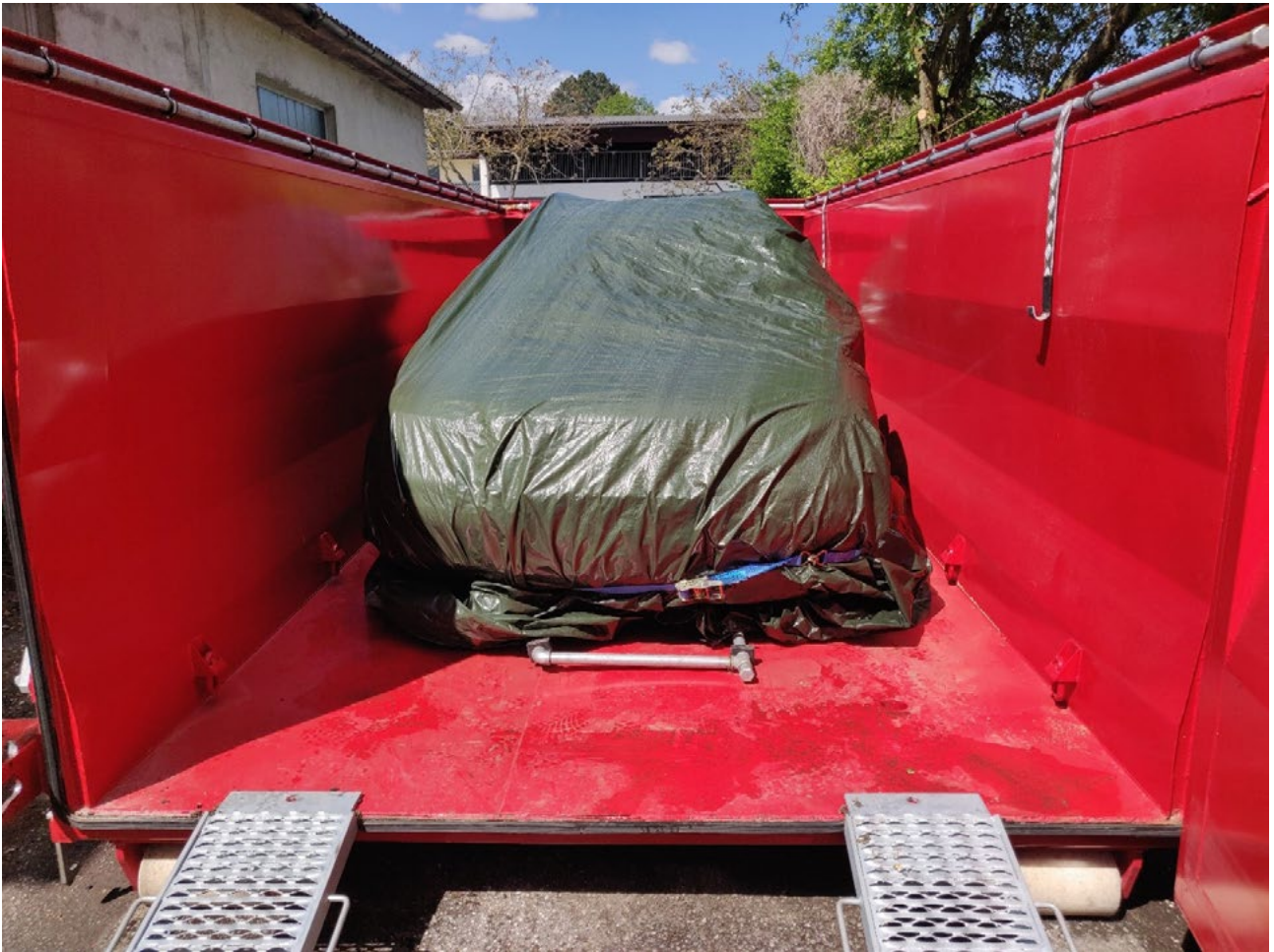
Abbildung 9: Hier wurde das Fahrzeug mit geöffneten Seitenfenstern in einer Plane verpackt, weil zuvor noch kein Wasser an die Batterie gelangt ist (bis dato keine Brandbekämpfung)
