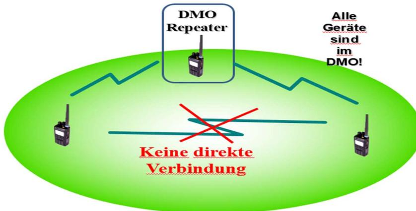
Anwendungen gibt es im Atemschutzeinsatz, um tiefere Funkverbindungen ins Gebäude zu erreichen oder z.B. als „automatische Übermittlungsstation“ an einem funktechnisch guten Standort.
